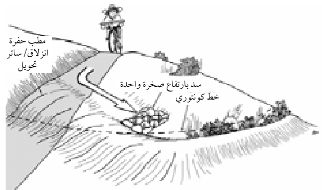
الشكل 21.3. مطب حفرة انزلاق/ساتر تحويل يوجه الجريان السطحي من الطريق إلى مزروعات في منخفض كونتوري.
