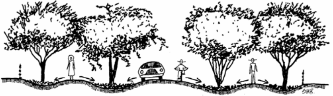
الشكل 16.4. ارفع الممرات، واخفض الأحواض المغطاة بمهاد والمزروعة بنباتات
