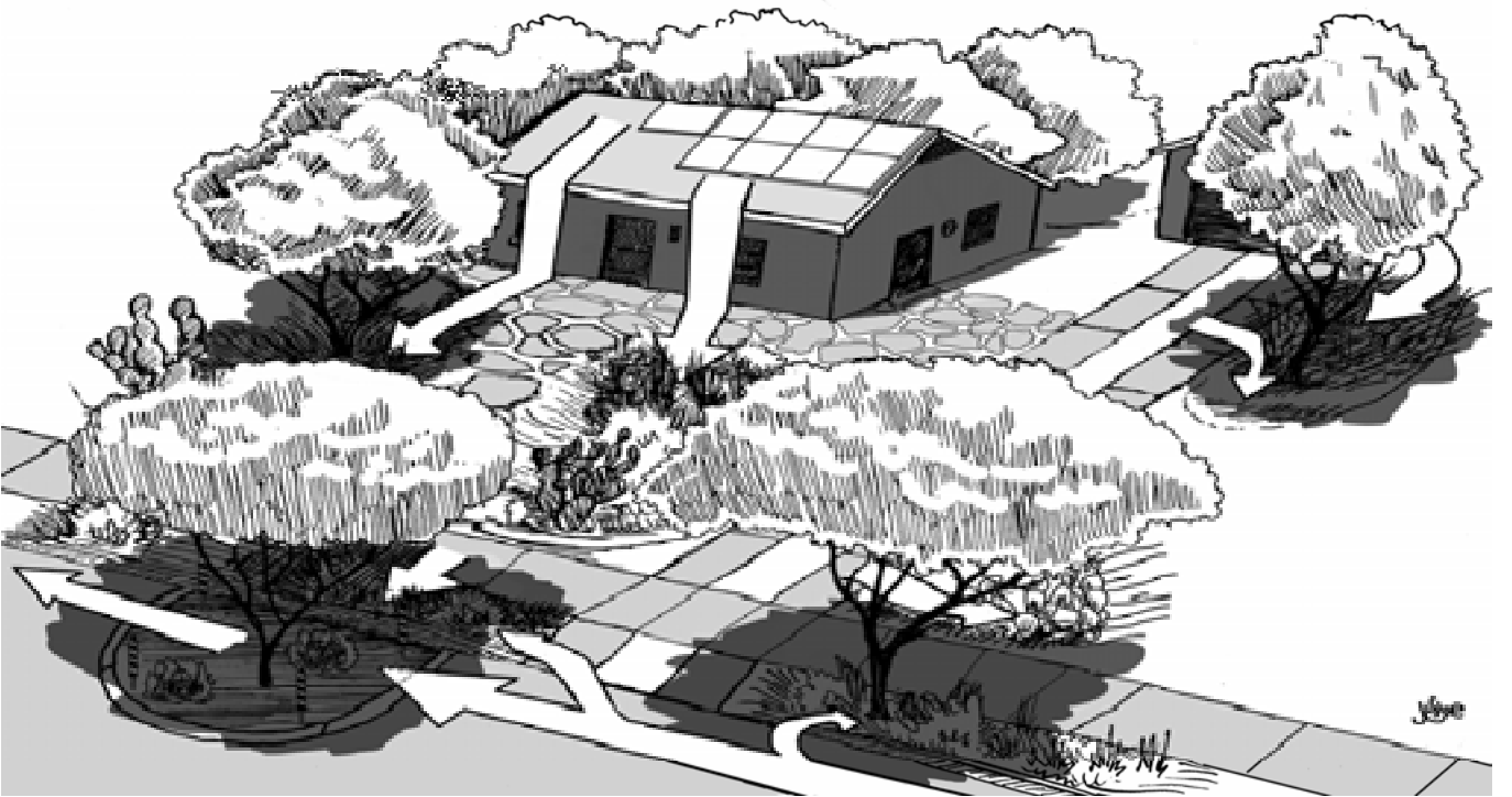
الشكل 18.4 ب. قطعة أرض سكنية رطبة ومظللة تسود فيها سدود حصاد مائي ترابية ونباتات محلية ذات استهلاك منخفض للماء وأرصفة ذات نفاذية بتحدر ذات تدرج يعمل على تقليل الجريان السطحي إلى الحد الأدنى والاستفادة منه في الموقع.
