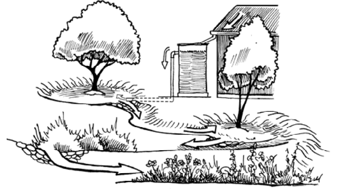
الشكل 17.1. يتم توجيه الماء الفائض من خزان إلى حفرة ترابية ويملؤها ومن ثم يفيض منها ليملاً حفرة أخرى وأخرى.
