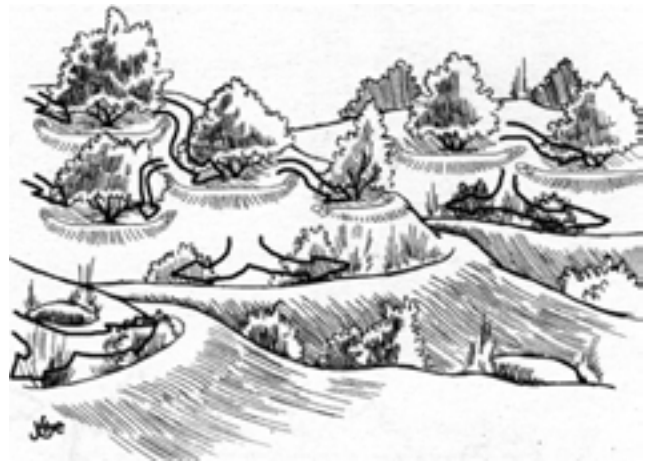
الشكل 4.3. سلسلة من السواتر الملتوية والكونتورية على موقع خارجي منحدر. وتشير الأسهم إلى تدفق الماء المنتشر والمتسرب بواسطة السدود الترابية.
